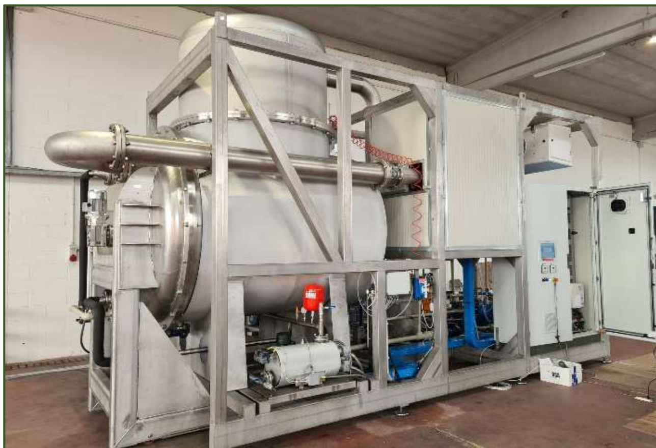
Figura 4.2/VI: Impianto evaporatore-concentratore
